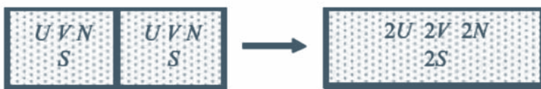
Figura 2.2. La combinación de dos sistemas equivalentes, es decir, con iguales número de moles, volumen, energía interna y entropía, producen un sistema con el doble de cada una de esas cantidades.
